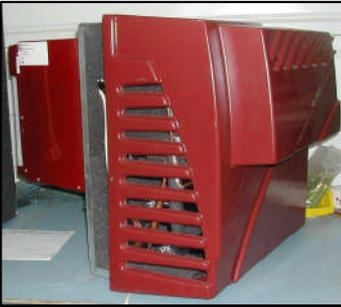
1) Déposer le capot arrière en retirant les 5 vis à l'aide d'une clef de 7 pour accéder au compresseur
