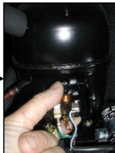
4) Retirer le relais (enfiché sur le compresseur) puis déconnecter les câbles du relais
