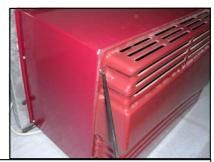
1) Déposer le capot avant à l'aide d'un tournevis cruciforme (4 vis à l'avant et 4 vis à l'arrière)
