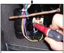
8) Retirer le condensateur (fixé sur le compresseur)
