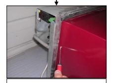
Déposer le capot supérieur à l'aide d'un tournevis TORX AZX
